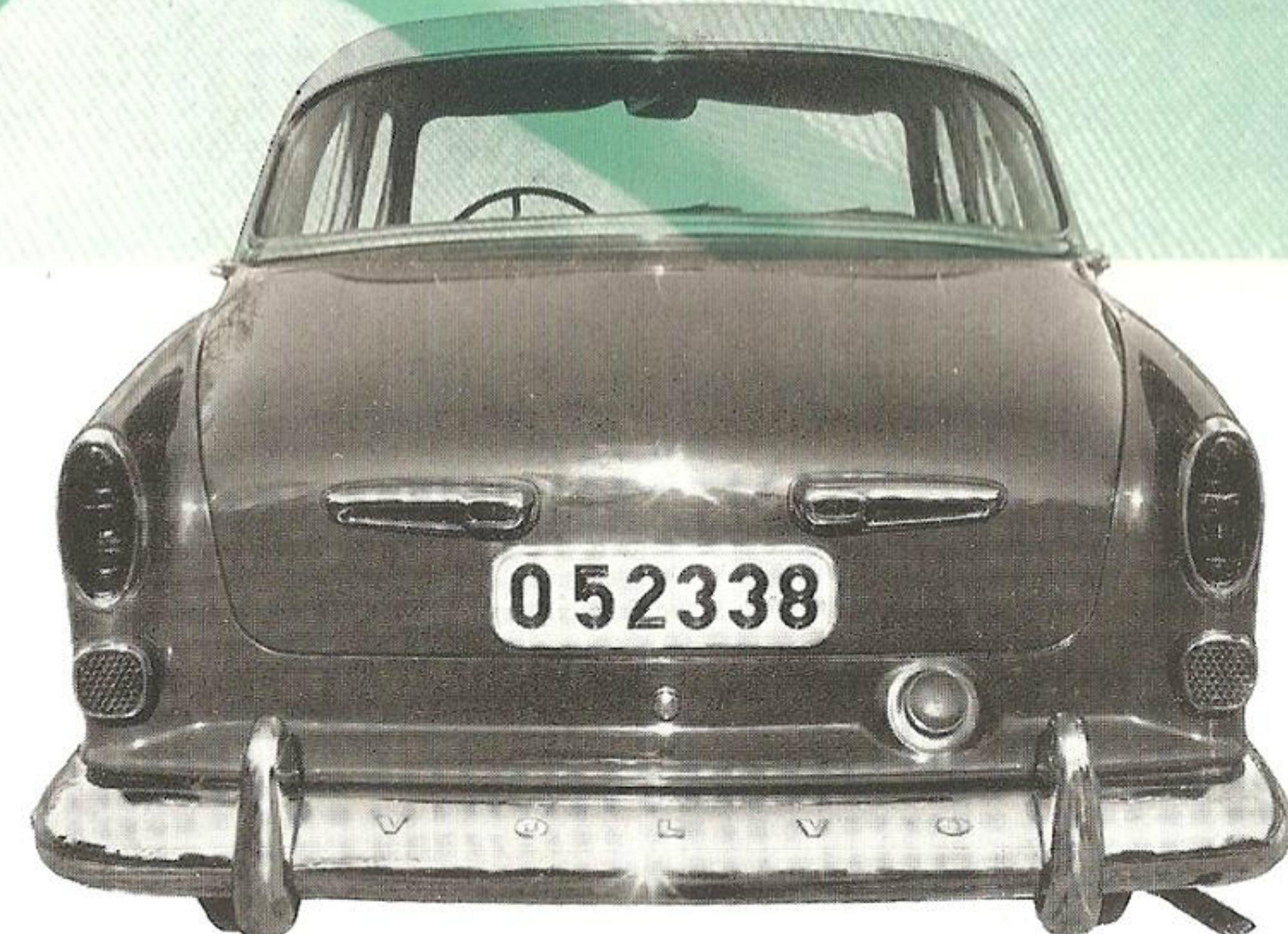
Friskluftsintaget är placerat omedelbart framför vindrutan. Den stora välvda bakrutan ger en utomordentlig sikt. Baklyktorna har fyra ljusfunktioner: 1. Bakljus. 2. Stoppljus. 3. Blinkers. 4. Långtidsparkeringsljus. Separata kraftiga reflektorer bak. Dubbel nummerplätsbelysning. Baklucka med tryckknappslås. Rymligt bagageutrymme med stående reservhjul. Plats för reservtank vid sidan av reservhjulet. Långtidsparkeringslampor såväl fram som bak.
