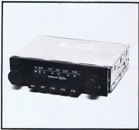
RADIO Tre modeller: FM/AM, FM/MW/LW och MW/LW. Tryckknappar för snabbinställning av önskade stationer.
