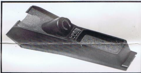
FÖRVARINGSFACK Med urtag för 60 mm klocka eller instrument. Komplet med 3 strömbrytare och varningslampa. (Passar även 140-serien t.o.m. 1970 års modell.)
