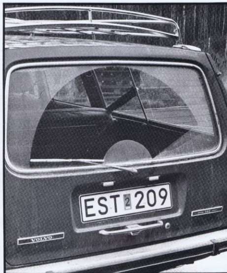
BAKRUTETORKARE MED SPOLARE Ger snabbt klar sikt bakåt. Volvo 145 t.o.m. 1969 års modell är förberedd för montering med elledningar för torkar- och spolarmotor.
