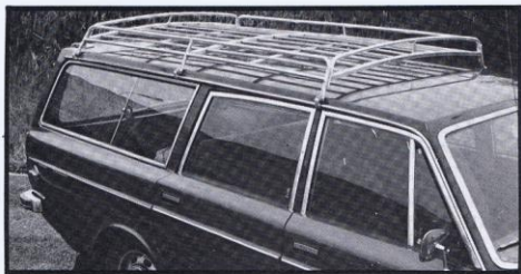
TAKRÄCK Av elförzinkade profiljärn och stålrör. Lastytan utgörs av 9 st lackerade träribbor. Fästs i dropplisterna med sex fastpunkter.
