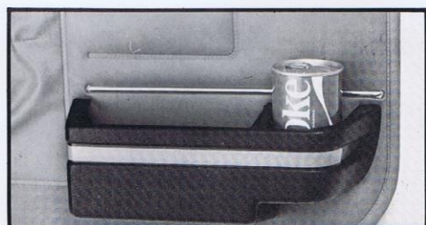
DÖRRFACK Tillverkat i ett oömt plastmaterial. Textilmatta i botten. Forsett med rött reflexband. Bra när dörren öppnas.
