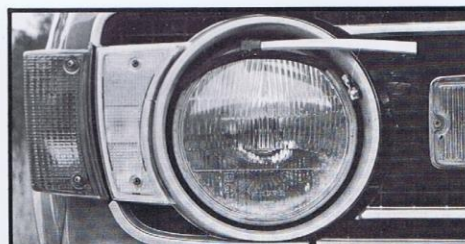
STRÅLKASTARTORKARE MED SPOLARE Renna strålkastare ökar sikten och därmed trafiksäkerheten. Nedsmutsade strålkastare kan försämrat sikten ända upp till 80%.
