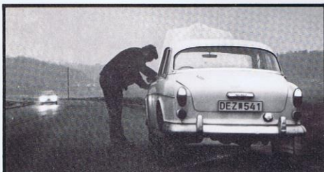
VARNINGSBLINKERS Används i nödsituationer och varnar trafikanten i god tid. När knappen för varningsblinkern dras ut blinkar alla fyra blinkerlamporna samtidigt. (Passar även 140-serien t.o.m. 1970 års modell.)
