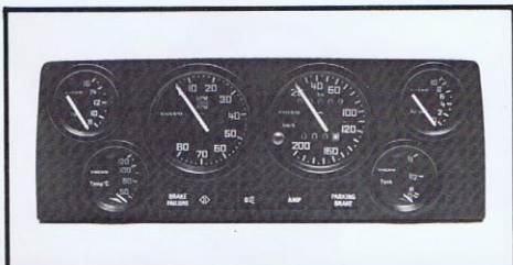
GT-INSTRUMENT Med hastighetsmätare, varvräknare, voltmätare, temperaturmätare, oljetrycksmätare och bränslemätare. Instrumentet är direkt utbytbart mot standardinstrumentet. (Passar 1973 t.o.m. 1974 års modeller. Och GL—DL-modellerna t.o.m. 1972.)
