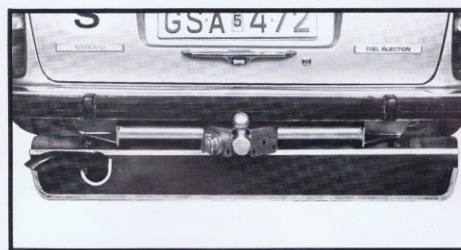
STENSKYDD Skyddar bakomvarande fordon och din egen bils bakre underrede mot stenskött.
