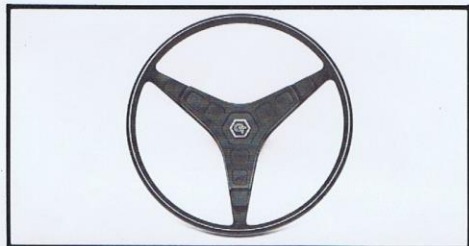
GT-RATT Mindre än den vanliga ratten. Energiupptagande. Uppfyller högt ställda säkerhetskrav. (T.o.m. 1972 års modell.)
